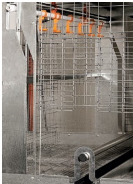
Geöffnetes Trenngitter, höhenverstellbare Sitzstange über dem Trog, höhenverstellbare Tränkelinie
