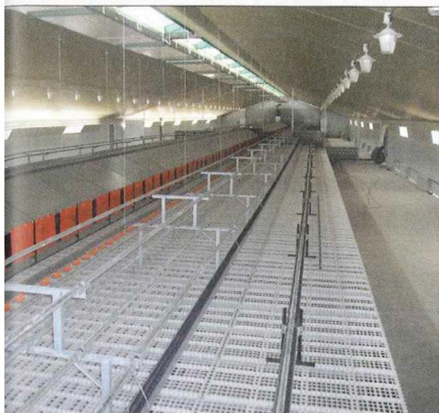
► composé d'une charpente traditionnelle, de panneaux en mousse polyuréthane de 40 mm au plafond et de panneaux sandwichs de 50 mm sur les côtés. Il est de couleur gris clair (RAL 9006) avec une couverture gris plus foncé (RAL 7042) afin de répondre aux exigences d'intégration paysagère.
